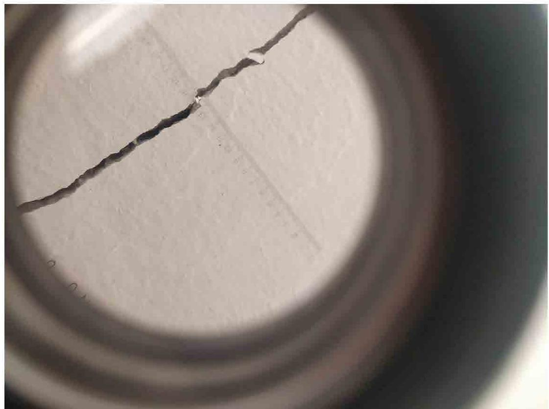
Фото 6. Ширина раскрытия трещины до 0,5 мм
